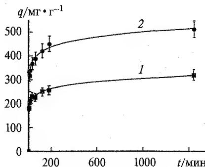
Зависимость сорбции ( $q$ ) иттрия на нанодисперсном (1) и ферментативном гидроксипатите (2) от продолжительности контакта.
